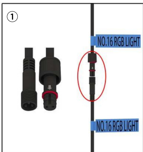
① Connectez deux fiches de bande LED avec les mêmes étiquettes. (Trouvez les flèches sur les deux câbles et connectez-les, puis serrez les capuchons.)
